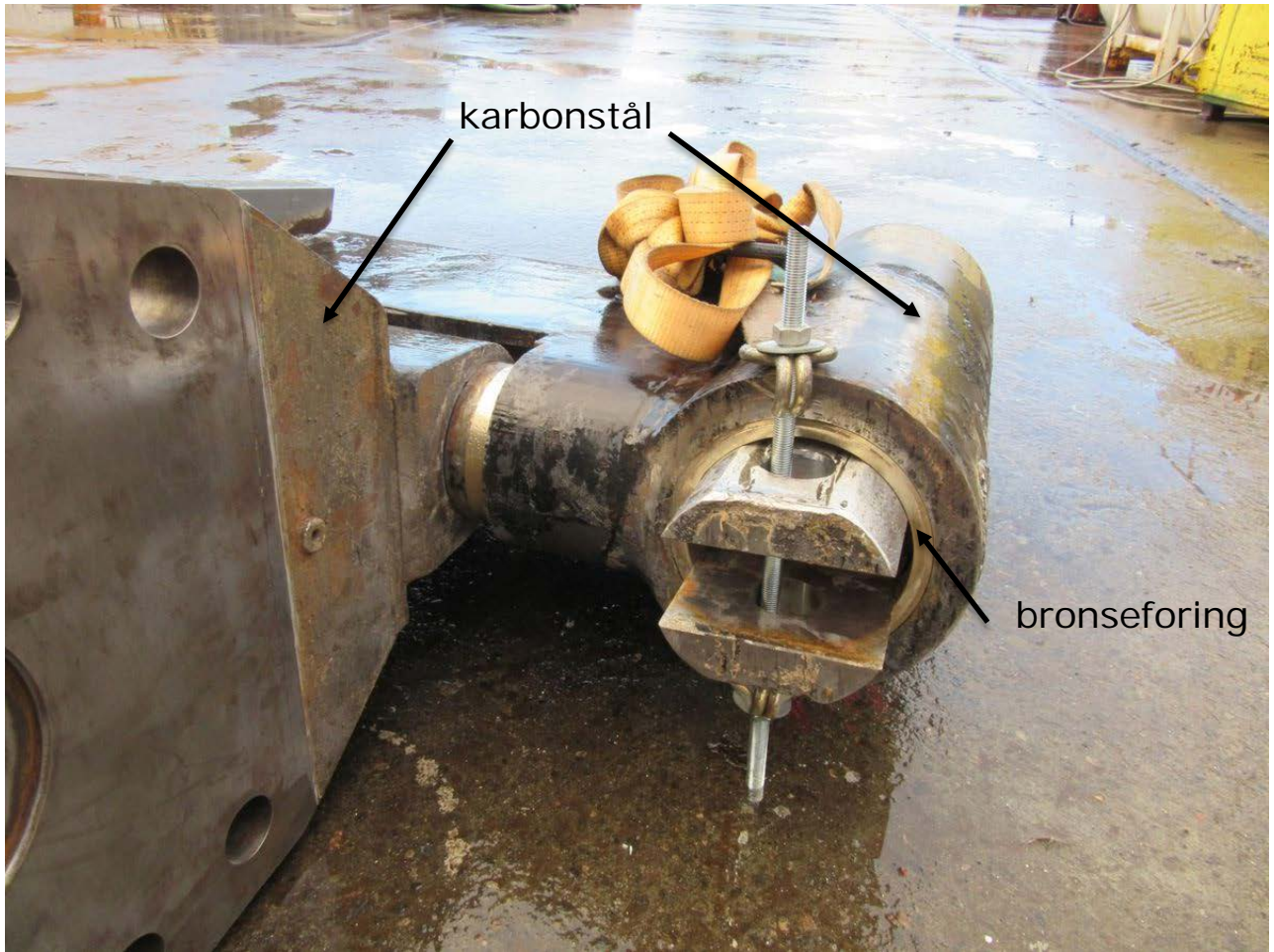
Figur 4-33 Ferdig montert rør med rorflaps og bronseforing i lenkeforbindelsen markert med pil
