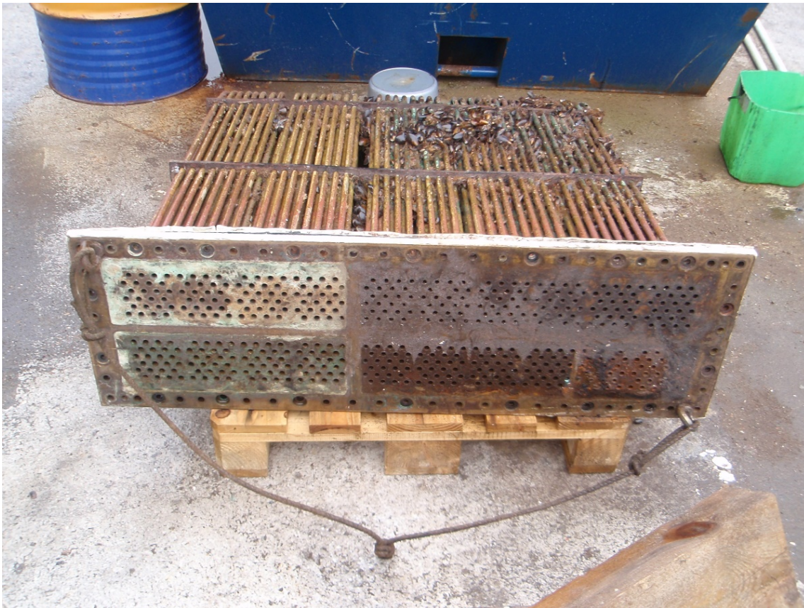
Figur 4-24 Bokskjøler demontert fra sjøkisten i Figur 4-23
